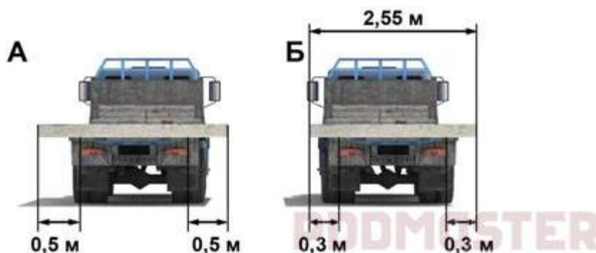
**На каком рисунке изображен автомобиль, водитель которого нарушает правила перевозки грузов?**
